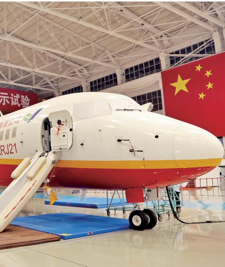
内按照试验条款要求形成一片漆黑的环境。机长在驾驶舱地板灯熄灭后，通过旅客广播宣布：“旅客撤离！撤离！撤离。”副驾驶则迅速打开应急灯光。与此同时，比“乘客们”的惊呼声来得更快的是乘务员迅速地大声指挥：“全体乘客听我指挥，现在立即松开安全带。”2名乘务员以敏捷的身手迅速、准确地做出判断并打开了2个可用出口。应急撤离滑梯在3秒钟内自动完成充气，向外弹出并连接到地面。54秒…55秒…，还剩4人；56秒…还剩2人；57秒，最后一名“乘客”安全到达地面，ARJ21-700飞机全机地面应急撤离试验宣告成功！
