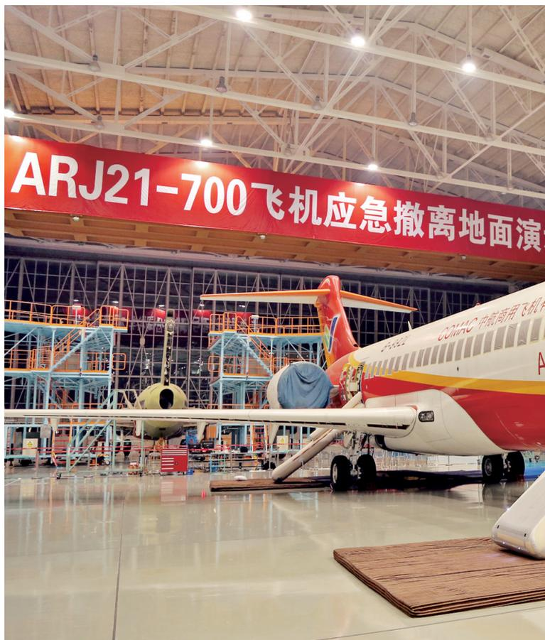
局方选定的出口数量仅为飞机实际出口数量的一半，即 2 个出口，试验条件可谓相当严苛。
