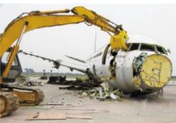
**民航资源网** 12 月 10 日，广州飞机维修工程有限公司（简称“GAMECO”）与 Jet Midwest 公司合作，开始对一架波音 767 飞机进行拆解。这是 GAMECO 首次开展报废飞机拆解业务。飞机拆解后，一些可用的部分，例如发动机、起落架和机载零部件等可以出售，再装机利用。而飞机蒙皮等可以作为废旧金属回收利用。飞机拆解回收业务在国外开展已经多年。理论上，一架飞机的 90% 能被回收再利用。
