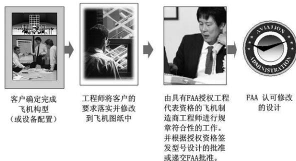
图3 美国飞机构型设计取证图
