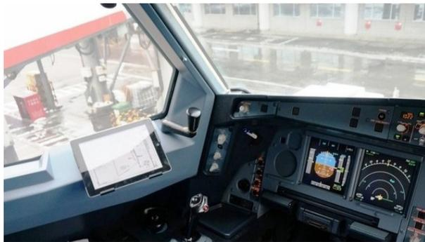
图 4 东航 A330 机队加装 EFB 设备
