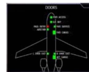
图 3 ARJ21-700 驾驶舱 EICAS 舱门简图页
