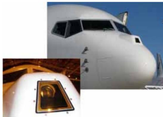
图 2 安装了 EFVS 系统的民航客机
